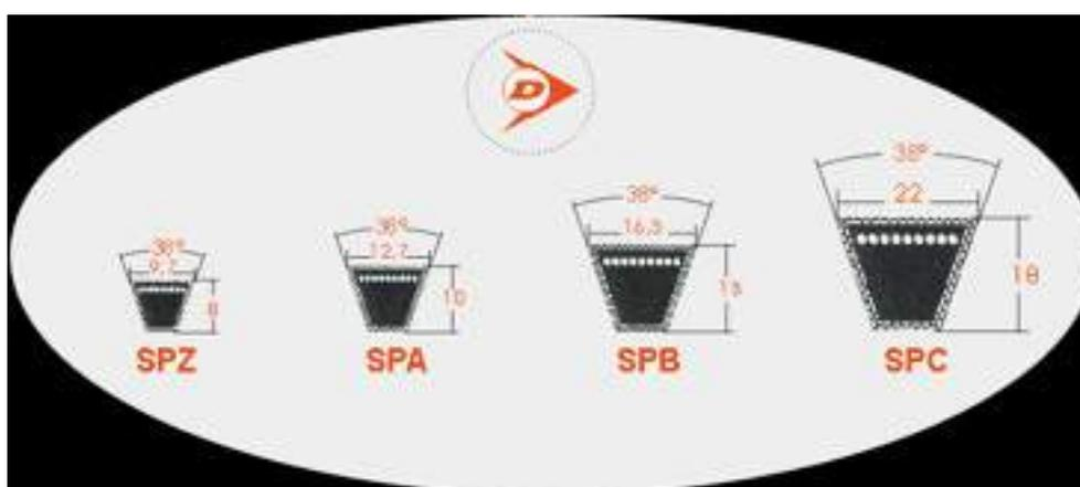
Fabricadas bajo norma RMA-MPTA (EEUU) y BS 3790 (UK), estas correas permiten realizar las más variadas transmisiones en espacios reducidos. Al igual que las correas de sección SP, éstas presentan las mismas características. Se ofrecen en 3 secciones.
