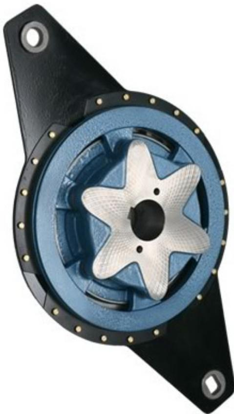
El funcionamiento de estos frenos es del tipo "negativo" o "de seguridad". Esto se debe a que en ausencia de aire realiza la función de frenado. Al aplicarle aire comprimido el pistón-turbina vence la fuerza de los resortes, liberando al conjunto del disco de freno, permitiendo que el cuerpo enchavetado al eje gire. Al quitarle el suministro de aire, frena por la acción de los resortes.
